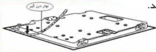
۳) اجاق گاز را در محل مورد نظر قرار داده و با استفاده از ابزار مناسب و بست های همراه مطابق شکل شاسی و اجاق گاز را به
